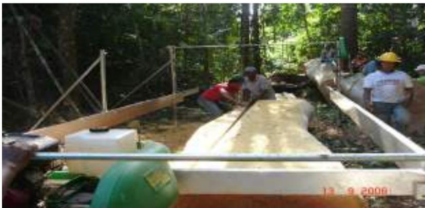
**FIGURA 06: Serraria portátil utilizada no Plano de Manejo do PAE**
